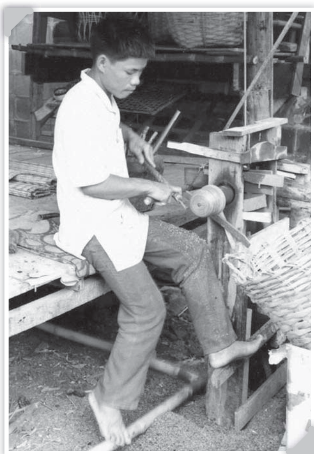
การกลึงหรือเคียนโครงสร้างไม้ไผ่ให้เรียบ ก่อนนำไปทาร์กในชั้นที่ ๔ - ๕
